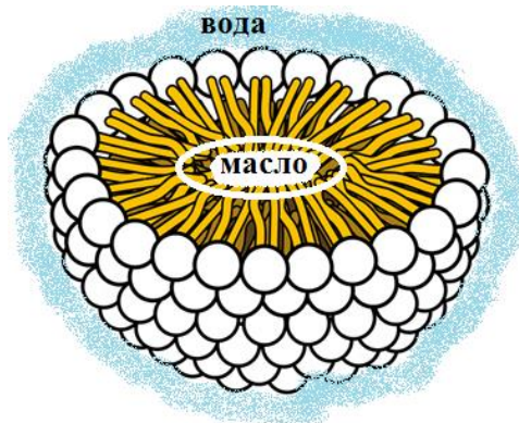
Рис. 11. Схематическое представление строения сферической мицеллы ПАВ типа «масло в воде» (боковое сечение)
