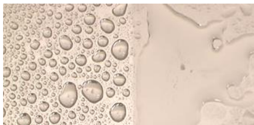
Рис. 18. Смачивание жидкостью твердой поверхности (слева) и растекание жидкости в результате полного смачивания поверхности (справа)
