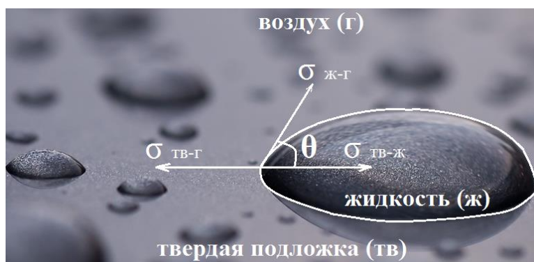
Рис. 1. Вектора сил, действующих на каплю жидкости, находящуюся на твердой подложке в воздушной атмосфере
